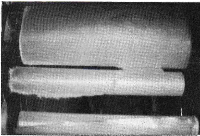
Foto 1. Alcuni rotoli in fibra di vetro di differente tela per la fabbricazione della vetroresina.
